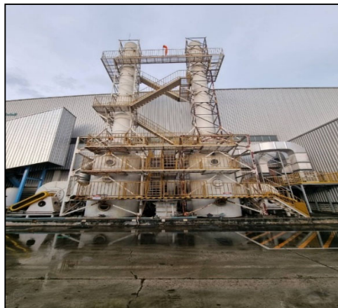
ภาพที่ 2.2 ระบบบำบัดมลพิษทางอากาศ (ระบบดักฝุ่นเปียก Wet Scrubber)
