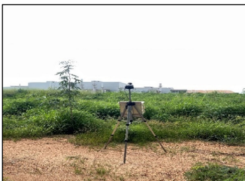
ภาพที่ 2.10 การตรวจวัดระดับเสียงรั่วของโครงการ
